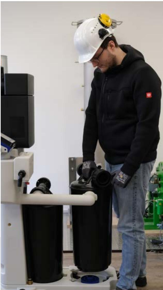
Das Risiko der Kontamination wird mittels hermetisch verschlossener Kartuschen zusätzlich minimiert. Blindstopfen und integriertes Bodenventil verhindern zuverlässig ein ungewolltes Austropfen.
